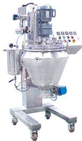
Лабораторный вертикальный вакуумный сушильный смеситель
