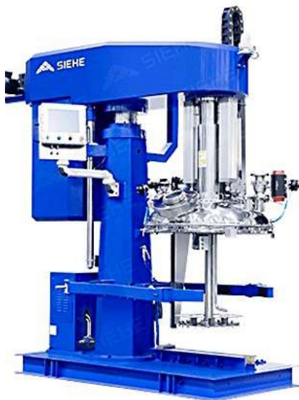
Рециркуляционный Вакуумный Диссольтвер со Скрепером
