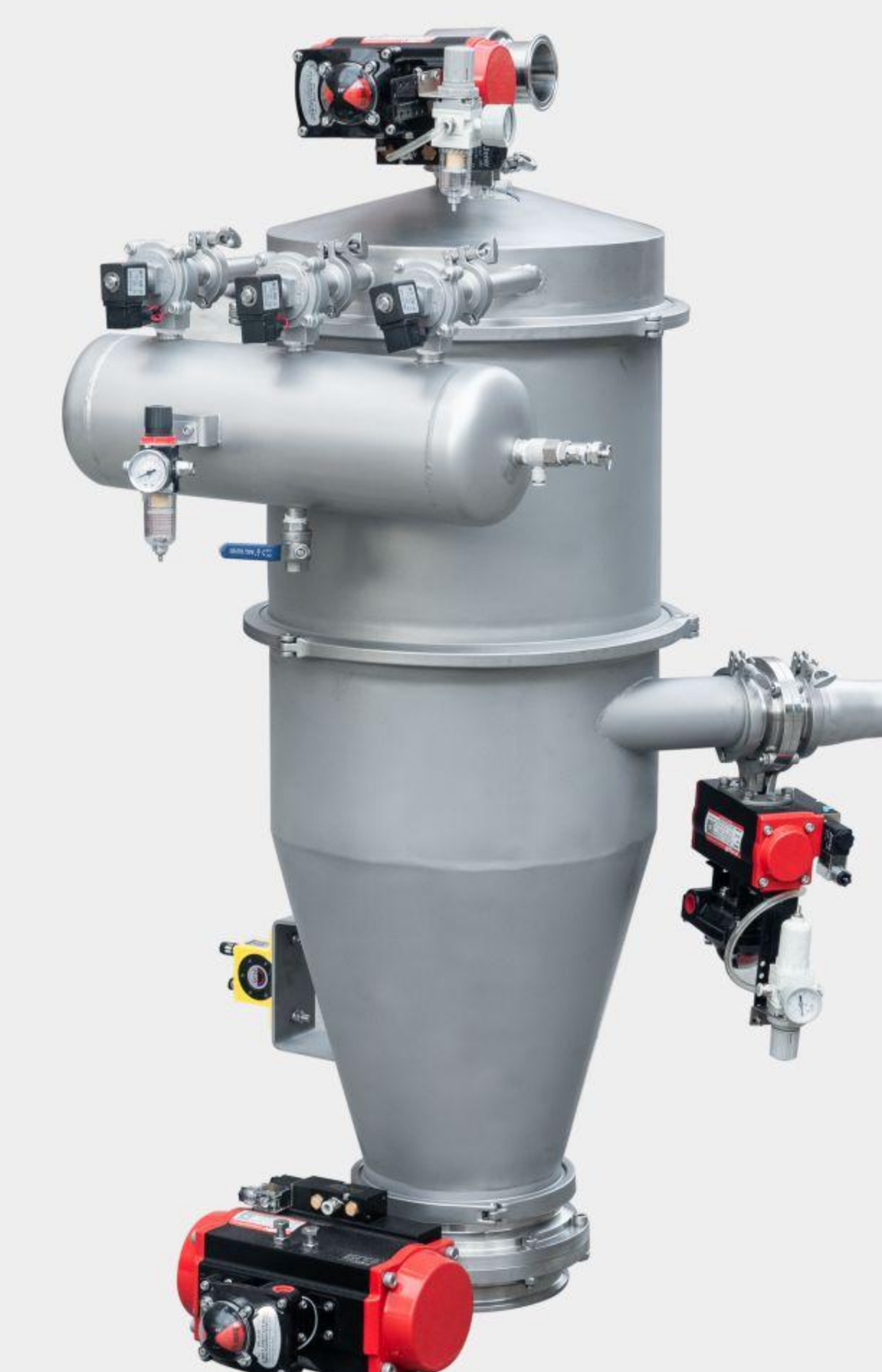
Транспортировка: вакуумный питатель
