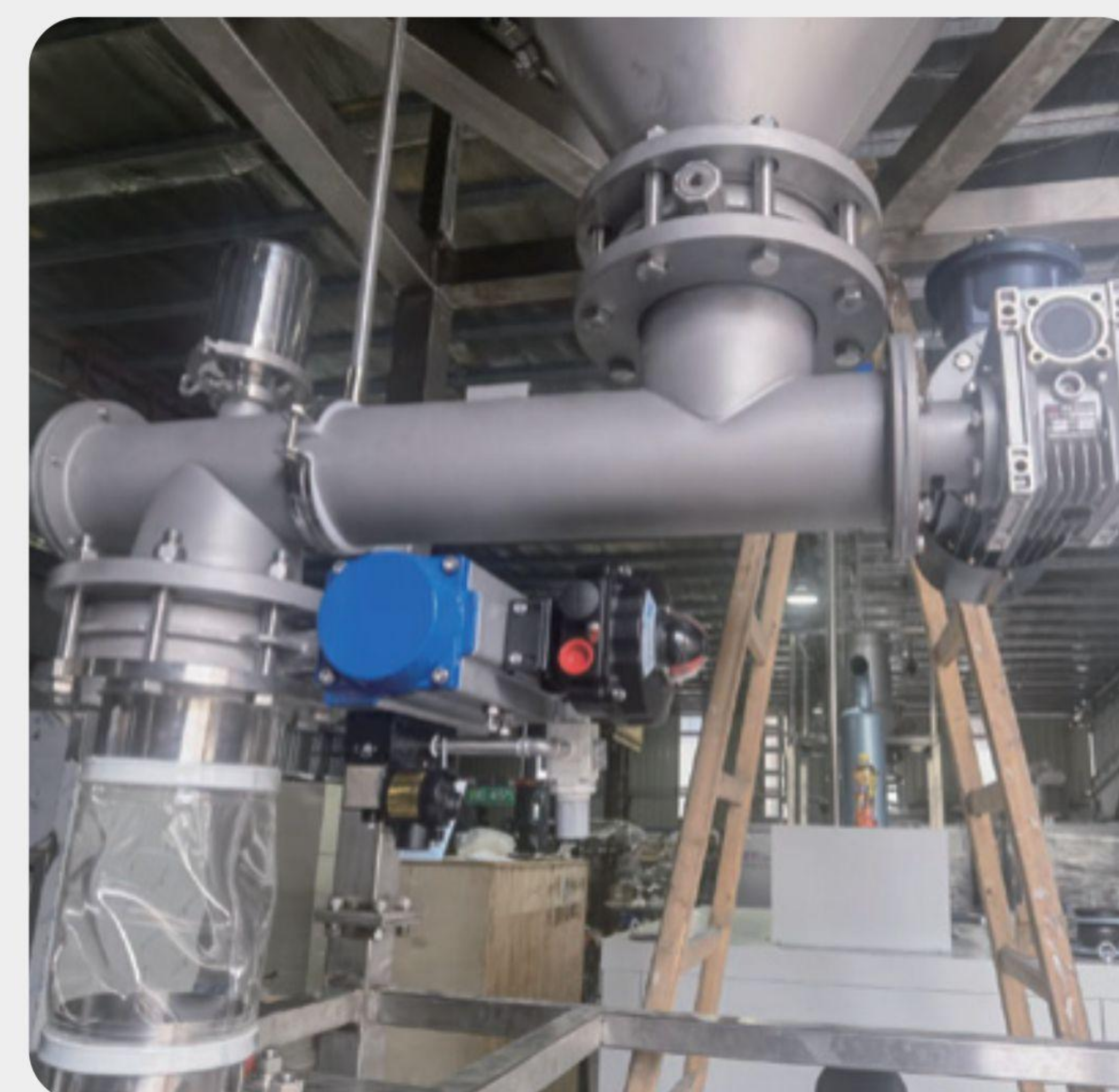
Дозирование подачи: шнековый конвейер
